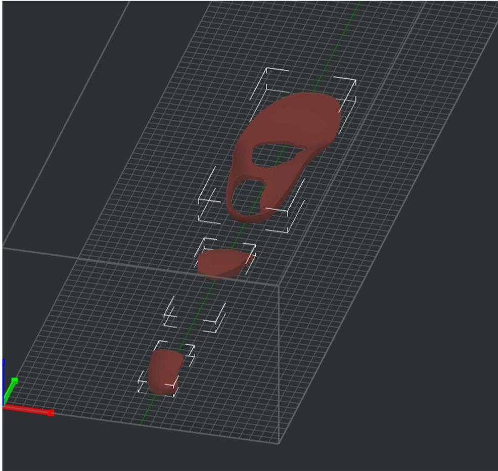
Ausgewählte Modelle werden mit einem Rahmen um die Kontur gekennzeichnet.
