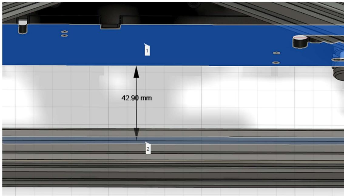
Die Länge des Belts kann variieren. Stellen Sie die Spannung über die Spannrollen individuell für den aktuell verwendeten Belt ein.
