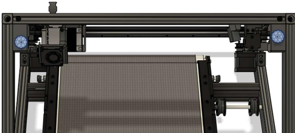
Die Spannung muss so gewählt werden, dass die Riemen nicht aus den Motorführungen rutschen, wenn die Motoren sich drehen. Die Zähne der GT2-Riemen müssen in die Kerben der Motor- und Umlenkrollen greifen.
