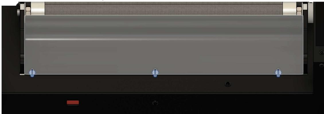
**! Drücken Sie die Schrauben beim Lösen nicht in Richtung des Elektronikgehäuses (unten), um Schäden an der Elektronik zu vermeiden.**
