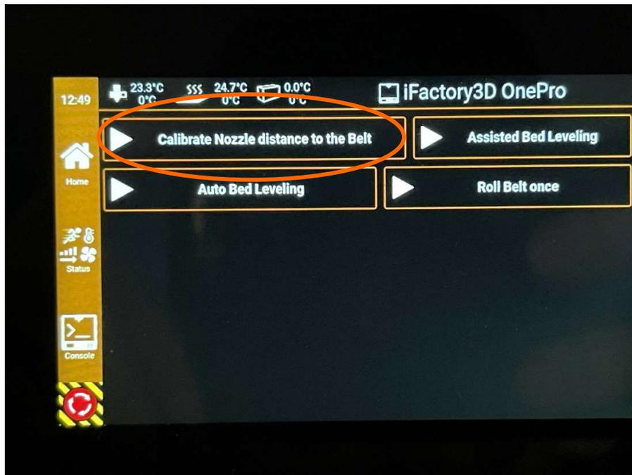
Stellen Sie die Distanz zwischen Düse und Druckbett ein. Wählen Sie hierzu "Calibrate Nozzle distance to the Belt" im Menü aus.
