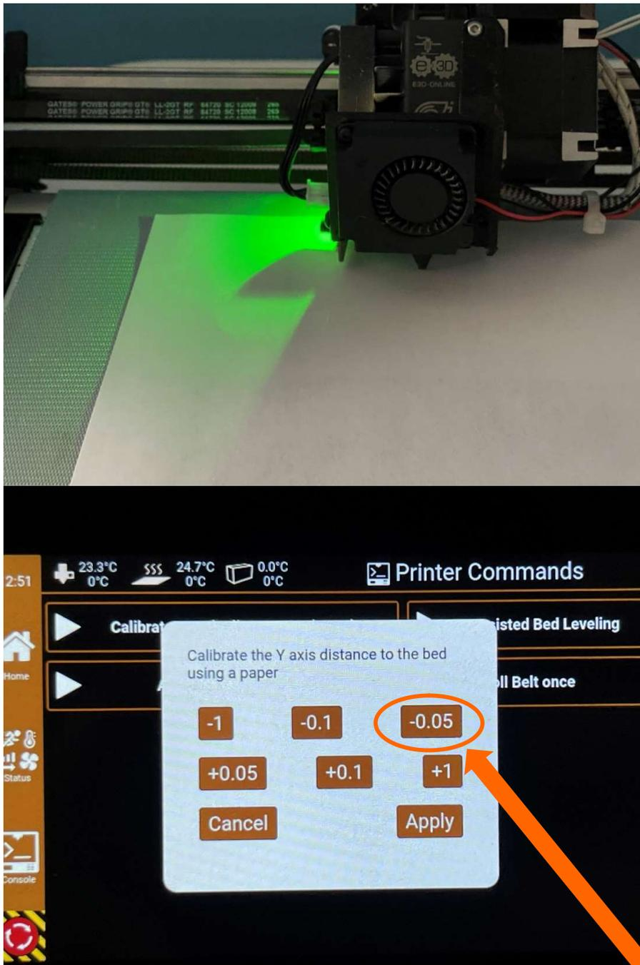
Schieben Sie ein Stück Papier (iFactory3D Kalibrierungskarte / Dollar) zwischen Düse und Druckbett. Fahren Sie den Druckkopf nach unten. Beginnen Sie mit [-1] – Schritten und wählen Sie kleinere Schrittweiten, sobald sich die Düse dem Fließband annähert. Fahren Sie die Düse so tief, dass sie leichte Spuren auf dem Papier hinterlässt, das Papier aber nicht eingeklemmt wird. Bestätigen Sie die Y0-Position mit "Apply".
